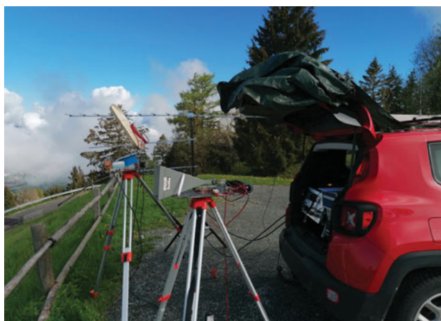
Stative mit Antennen und angebautem Transverter
