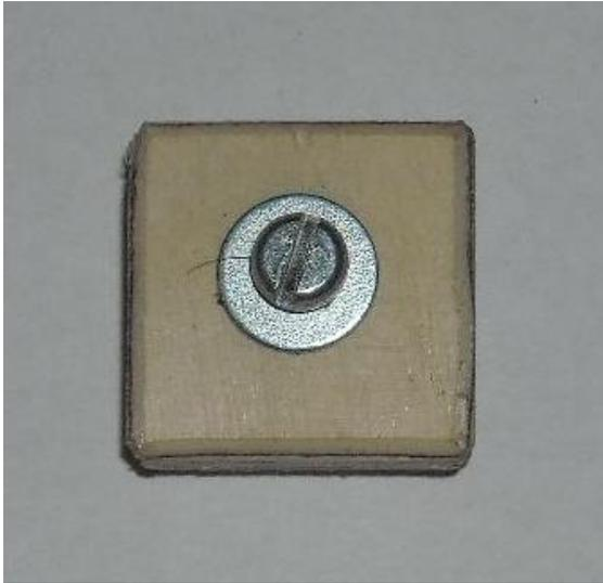
Wir beginnen mit der Taste: Nimm den kleinen Holzklotz, der „Taste“. Stecke auf die „Schraube A“ (die kleiner Schraube) die „Scheibe A“ (das ist eine der kleineren Scheiben). Steck diese dann in die Bohrung der „Taste“.
