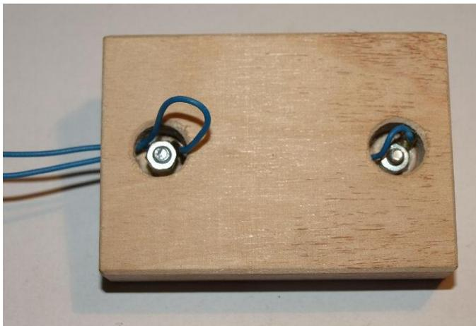
Lass auch hier eine kleine Schleife, damit sich die Mutter leichter auf die Schraube aufsetzen lässt. Setz die Mutter auf die Schraube und drehe sie ein wenig auf die Schraube.
