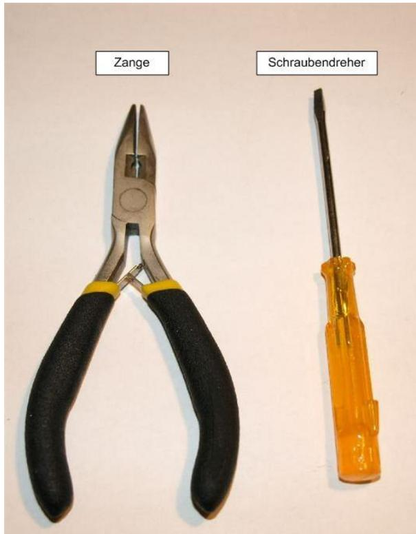
Mit der Zange kannst Du die Muttern festhalten, während Du mit dem Schraubendreher die Schrauben festziehen kannst.
